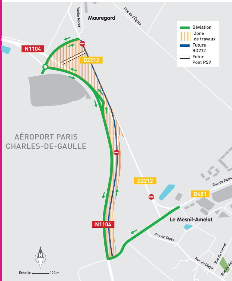
Dans le cadre des travaux du contournement Est de Roissy, la DiRIF réalise actuellement la future RD212, ainsi qu'un pont pour lui permettre de franchir à terme la nouvelle autoroute A104 au Sud de Mauregard. Pour ces travaux, une partie de l'actuelle RD2212 sera fermée à la circulation et une déviation via la RN1104 sera ainsi mise en place.
