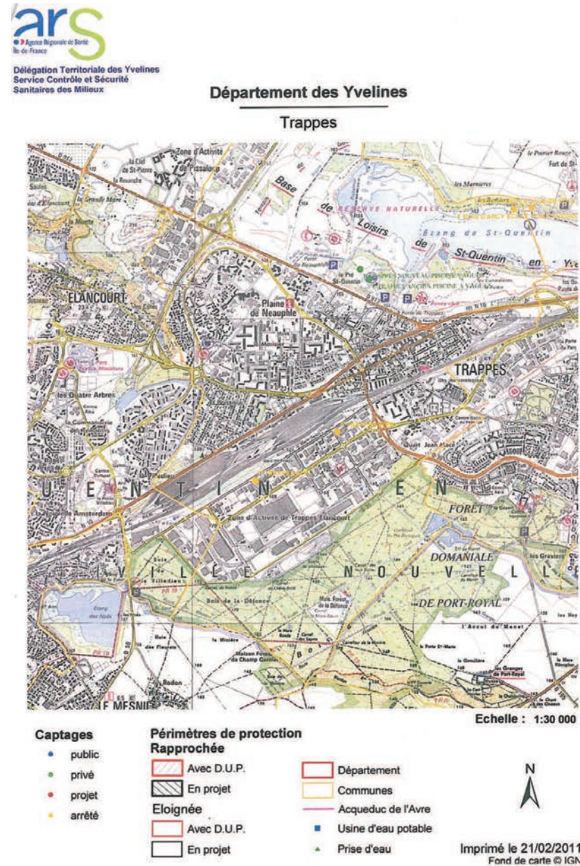
Figure 115 : Captages d'eau utilisés pour la production d'eau potable au niveau de l'aire d'étude (source ARS Île-de-France)
