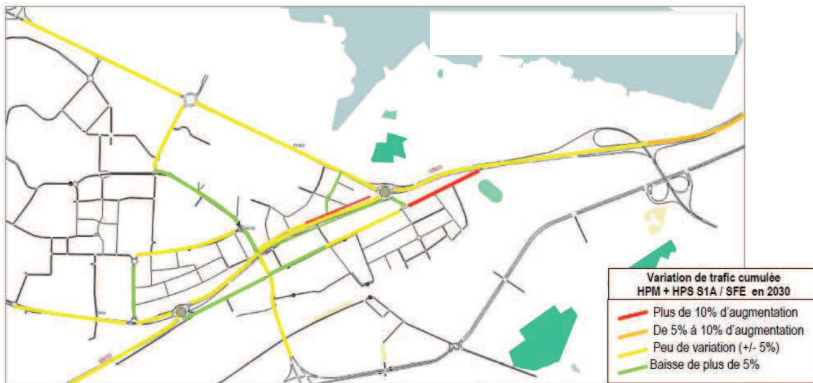
Figure 224 : Variation de trafic cumulée HPM +HPS S1A / SFE entre le scénario fil de l’eau et le scénario avec projet (source : Etude de trafic, SORMEA, Janvier 2015)
