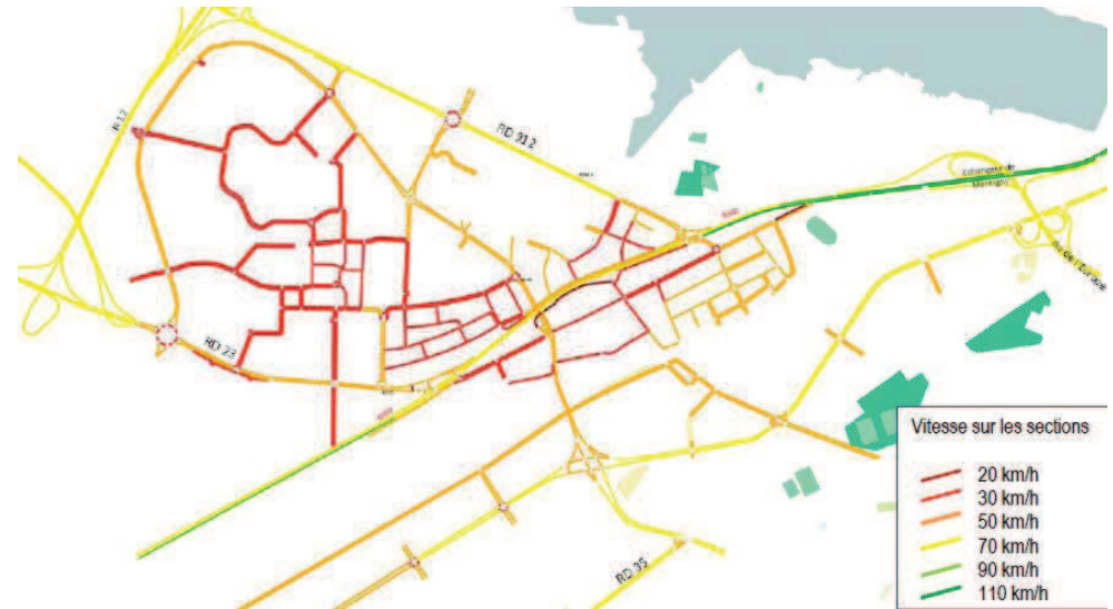
Figure 283 : Réseau modélisé et vitesses limites considérées sur chacune des sections (source : Etude de trafic, SORMEA, mars 2015)
