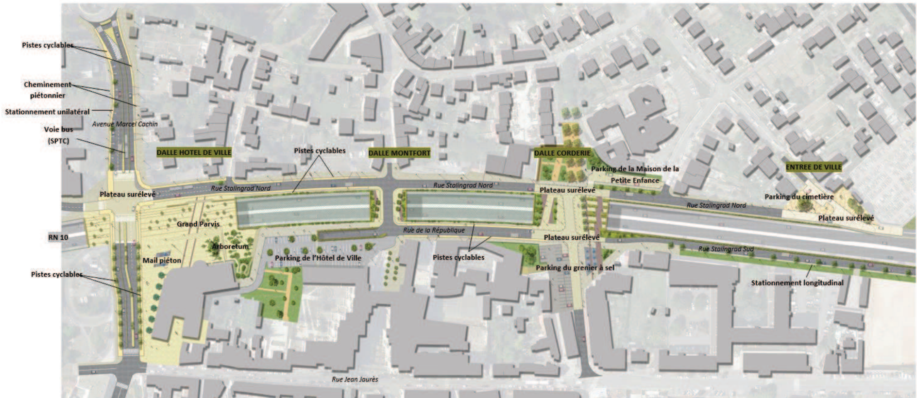
Figure 251 : Vue en plan générale du projet d'aménagement de surface du plateau urbain de la RN 10 (source : AVP AEI/Ingérop, 2012)
