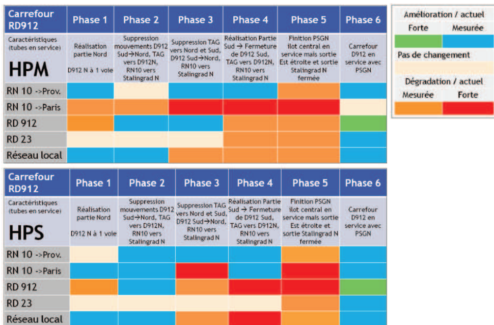
Figure 211 : Conditions d'écoulement du trafic aux heures de pointe lors de la réalisation des travaux au niveau du carrefour RN 10/RD 912 (source : rapport de simulations dynamiques des phases de travaux du scénario 1A, SORMÉA, mars 2015)
