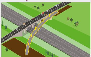
Une fois le tablier en place, les chaises à galet sont retirées et le viaduc est verrouillé sur ses appuis définitifs.
