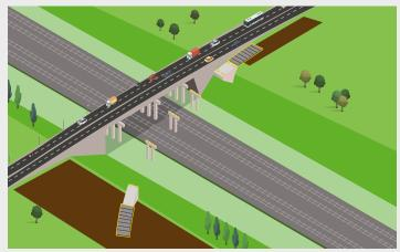
Le tablier est préassemblé dans l'enceinte du chantier, à proximité de la zone de lançage.
