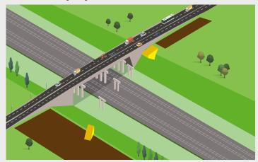
Les appuis extérieurs (**culées**) sont construits et l'espace autour est dégagé pour servir de plateforme d'assemblage et de lançage.
