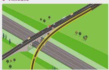
Une dalle en béton est coulée sur la structure puis couverte d'enrobés, équipée et connectée aux voiries.
